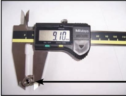
Comme la vis de fixation des supports de traverses débouchants est du M6, utiliser l'écrou à river aveugle correspondant de diamètre extérieur 9,1 mm.
